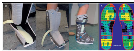
Abb. 2: a) Plantare Druckverteilungsmessung im VACODiaped, b) 3 Fußregionen
